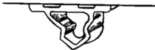
計算による強度確認を行う必要のない緊締金具及びすみ金具
